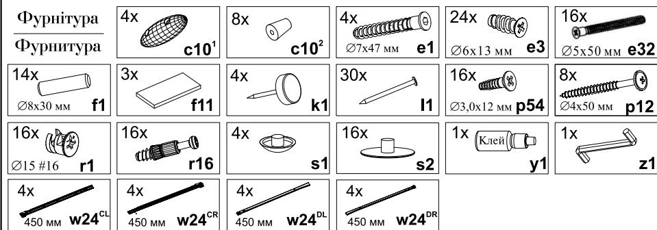
ІНСТРУКЦІЯ МОНТАЖУ | ИНСТРУКЦИЯ МОНТАЖА
